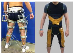
● 歩行アシスト機器・モータ駆動タイプ(左図)と受動的ゴム駆動タイプ(右図)
